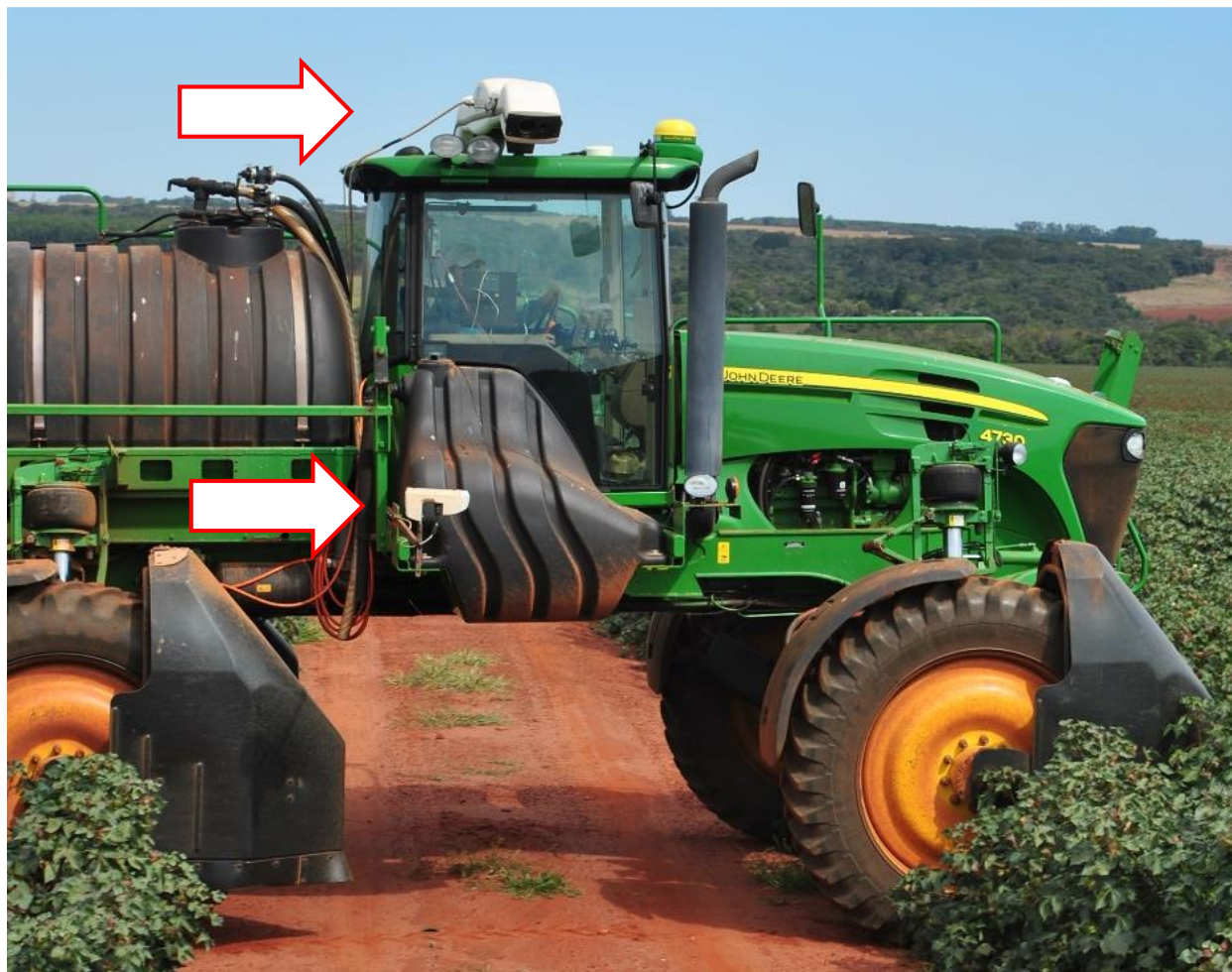
Figura 3. Posição instalada dos sensores multiespectrais Yara N-Sensor ® ALS (acima) e Trimble GreenSeeker ® RT 200 (no chassi) em um pulverizador JD 4730.
